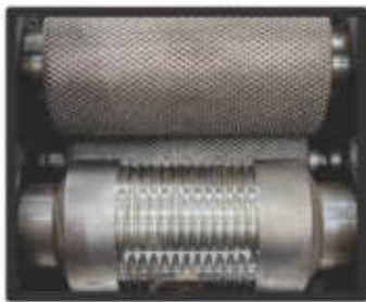
304 SOLID ROLLER (LASER CUT)
